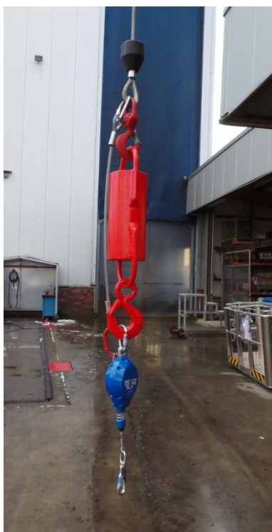
Afb.10-12 Redundante Beveiliging aan de kraanhaak:
