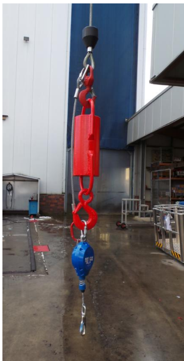
Afb. 10-7 Redundante zekering aan de kraanhaak
